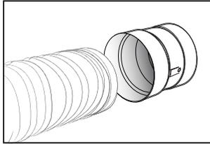
3. Tourner dans le sens inverse des aiguilles d'une montre jusqu'à ce que tout le filetage du connecteur de nettoyage de charpie serre bien l'extérieur du tuyau.
