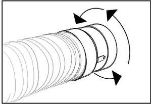
4. Pour fixer un tuyau à l'autre extrémité du connecteur de nettoyage de charpie, suivre à nouveau les étapes 1 à 3.
