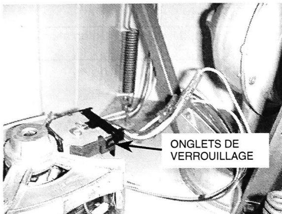
6. Branchez le connecteur du faisceau au moteur. Assurez-vous que le connecteur est complètement inséré sur le moteur et que les deux onglets de verrouillage du connecteur sont complètement engagés dans l'enveloppe de l'interrupteur.
