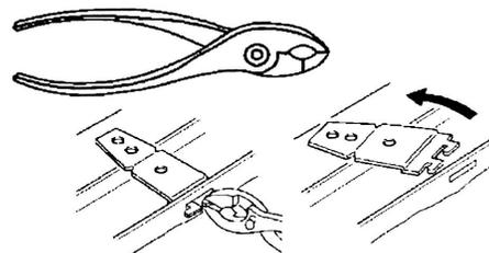
2. Pousser la bride dans la fente sur le côté du lave-vaisselle, et plier la languette sur le côté du lave-vaisselle afin de fixer en place la bride. Répéter cette étape sur l'autre côté du lave-vaisselle.
