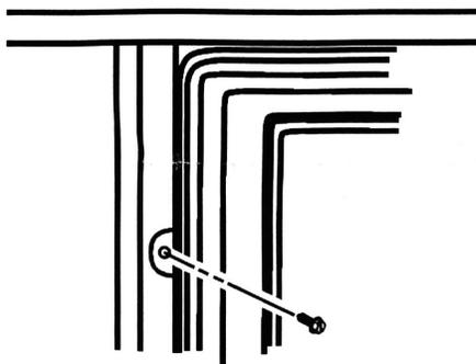
**REMARQUE :** Il est impératif de percer des avant-trous dans l'encastrement pour éviter toute fente dans le bois avant d'installer les vis.
